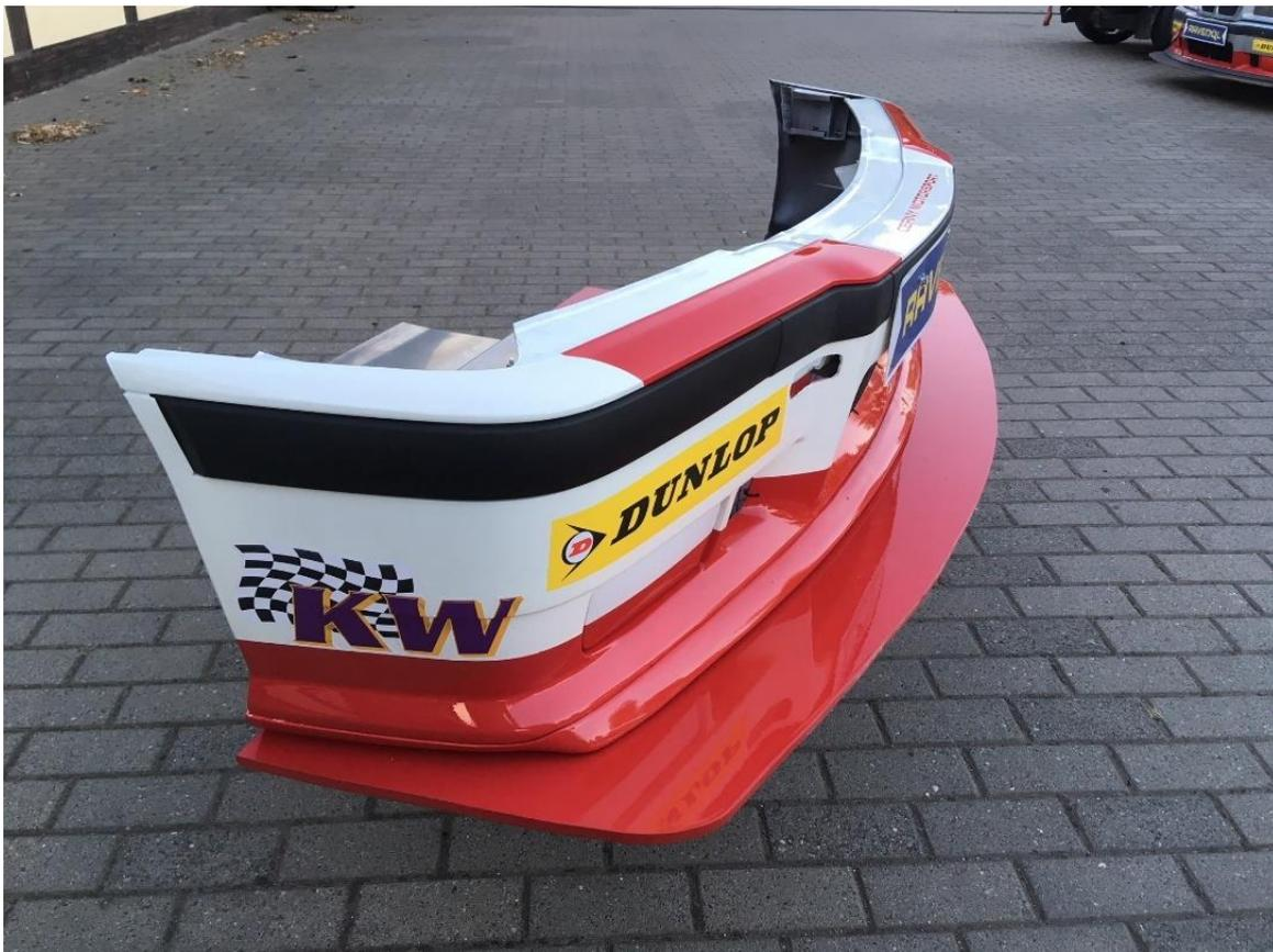
Abbildung 14 (Frontstoßstange mit Splitter)
